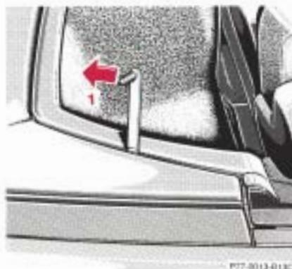
4. Rechten Verschluss des Verdeckkastendeckels entriegeln; Gabelschlüssel auf den Bolzen zwischen dem Überrollbügel und dem Verdeckkastendeckel aufstecken. Gabelschlüssel nach hinten drücken (1). Verdeckkastendeckel (2) senkrecht stellen.
