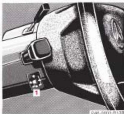
Einstellung in Längsrichtung: Schalter (1) nach vorn bzw. nach hinten schieben.
