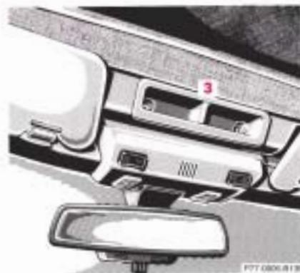
Wird der Verdeckschalter weiterhin gedrückt oder nach dem Loslassen innerhalb von ca. 2 Sekunden nochmals gedrückt, schließen die Seitenscheiben. Ein vorher aufgestellter Überrollbügel wird wieder aufgestellt.
