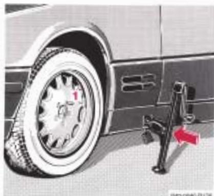
10. Oberste Radschraube heraus-schrauben. Zentrierbolzen (1) aus dem Bordwerkzeug in die Gewindebohrung schrauben. Restliche Radschrauben herausdrehen. Nicht in den Sand oder Schmutz ablegen.
