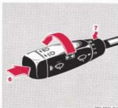
Blinken bei kleinen Richtungsänderungen = Kombi-Schalter nur bis zum Druckpunkt betätigen und festhalten.
